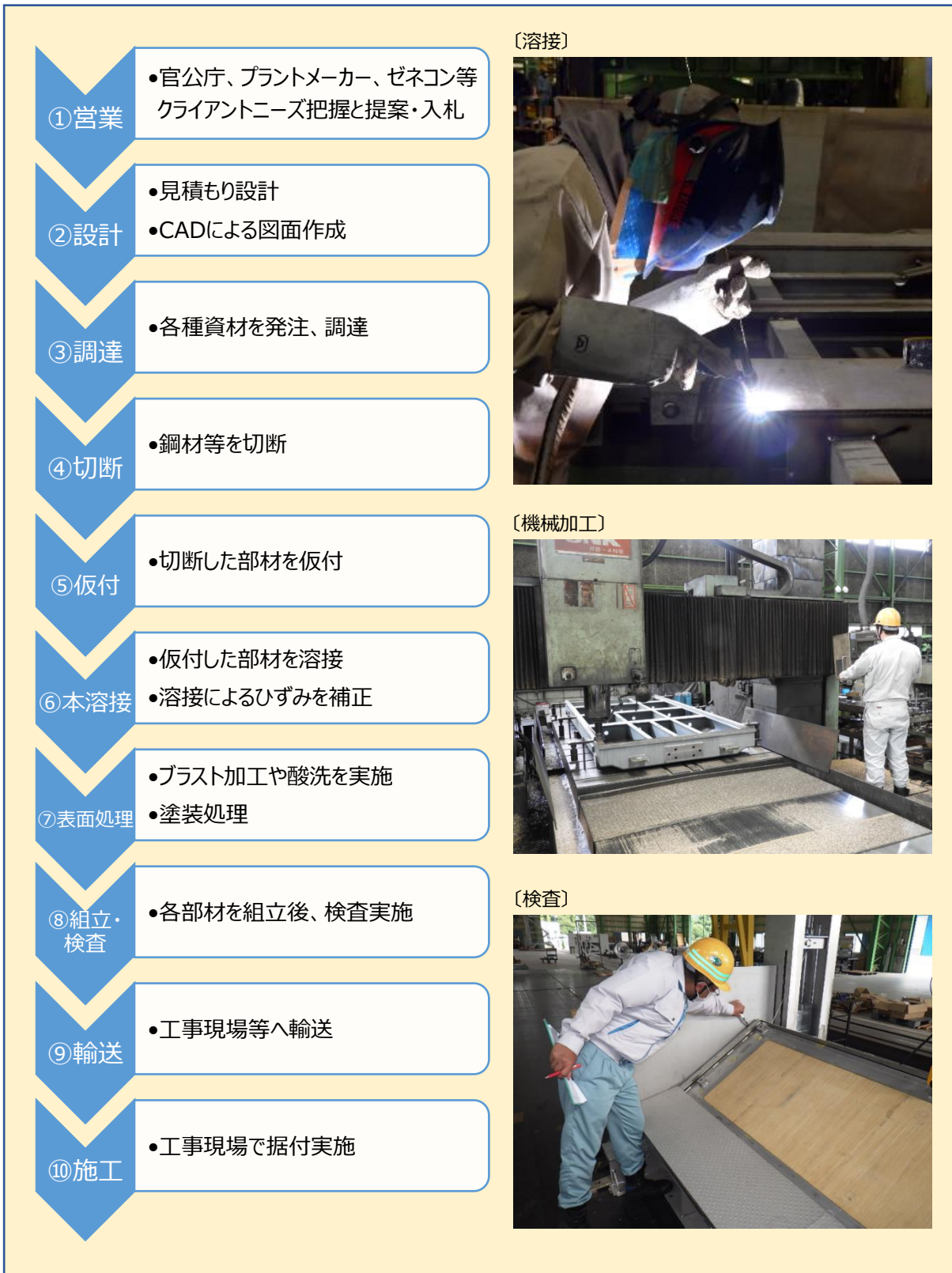
図表② 齊藤鐵工所の製品製造工程における業務フロー図 （出典：齊藤鐵工所からのヒアリングをもとに商工中金経済研究所にて作成。写真は同社提供）
