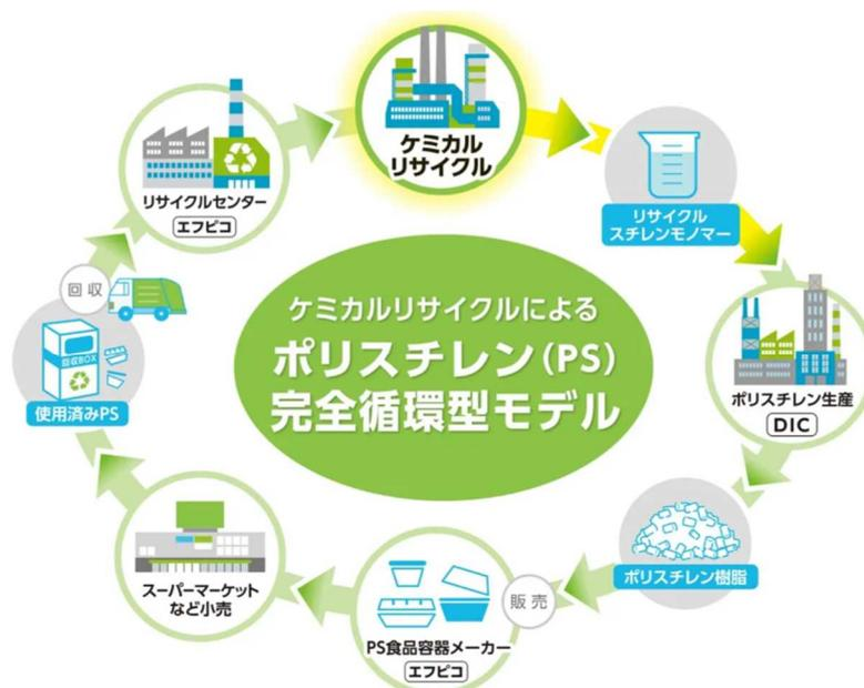
図 14 ケミカルリサイクルによるポリスチレンの完全循環型モデル<sup>17</sup>
