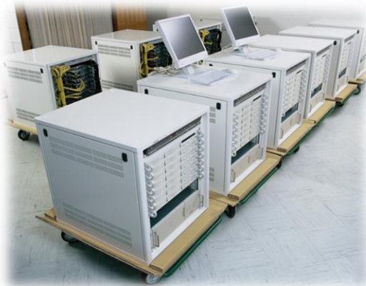
写真②：液晶 TV カラーフィルター画像処理検査装置
