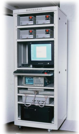
写真①：X線画像デジタル撮像素子評価装置
