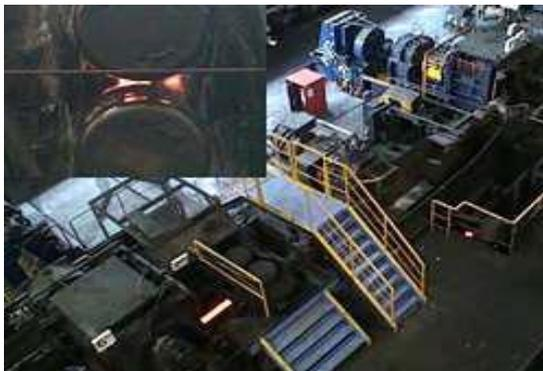
加熱炉で加熱されたビレットを2本のロールの間を通し、順次断面を小さくしながら長く伸ばし、狙い通りの形状に整える工程。粗列、中間列、仕上列に分かれており、全部で19スタンドある。最終ロールには、節、鋼種名、サイズマークが彫られており、これらは製品に転写される。
