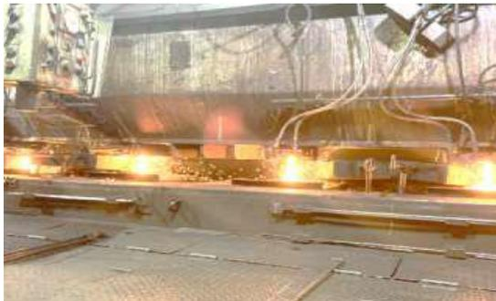
2次精錬された溶鋼は、連続铸造機に運ばれ、上下振動する鑄型に溶鋼を注入し、連続的に引抜きながらスプレイ冷却で外側から徐々に冷却し固めていく。最終的に溶鋼は140mm角の棒状に凝固・成形される。成形された鑄片は、所定の長さで切断しビレット（半製品）となり外観を検査・重量を測定の上、圧延工場に搬送される。
