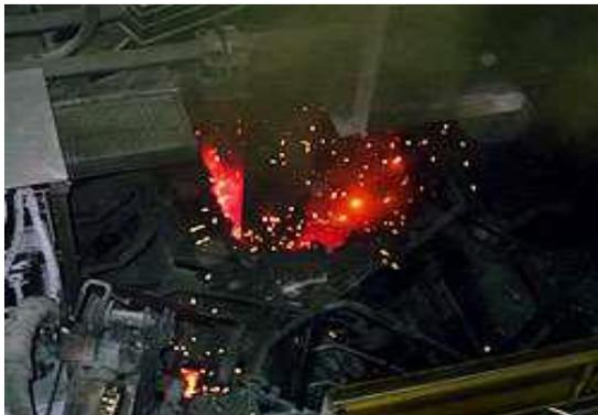
LFは2次精錬炉とも言われるように、電気炉から出鋼された溶鋼に対して2次的な加熱・精錬を行う工程。アルゴンガスで溶鋼を攪拌しながらアークで溶鋼を加熱し、カーボンやシリコン、マンガンなどの合金を投入して目標の成分調整と脱硫などの不純物を除去する。
