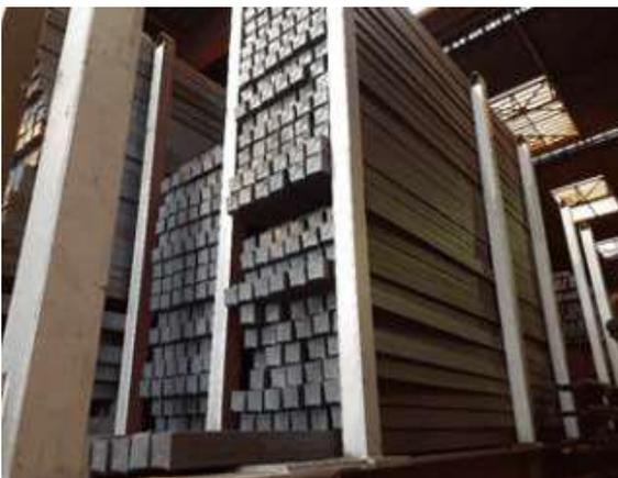
岸和田製鋼の製鋼工場にて製造。鉄スクラップを電炉にて溶解。用途に合わせて成分調整を行い棒状に铸造した鋼塊。主に当社圧延工場で使用している。アジアを中心に海外への輸出実績も多数ある。
