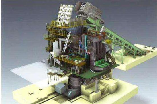
2001年に鋼材を高効率で再生させる電気炉（ECOARC）を世界初で導入した。熱効率が非常に高く、使用電気量は従来設備に比べ20%削減が可能である。
