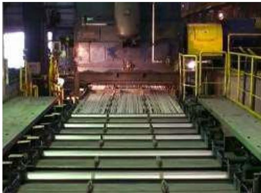
冷却床で冷やされた製品はさらに、一定数の本数と規定の長さ（3.5m～12.0m・0.5m 毎）に切断する。また、サイズに応じた所定本数をまとめて切断する。
