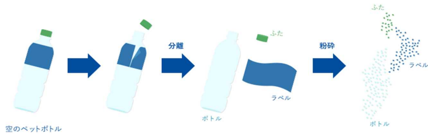
(図6：比重分離の仕組み)
