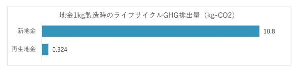
図 2:地金 1kg 製造時の GHG 排出量の比較10
