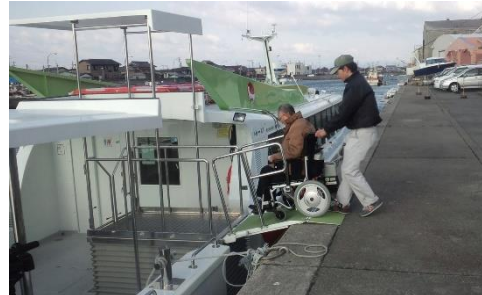
車いす用段差対象装置
