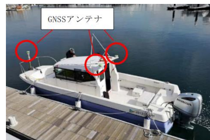
3基の衛星測位アンテナで高精度位置情報を取得 (内閣府 HP より)
