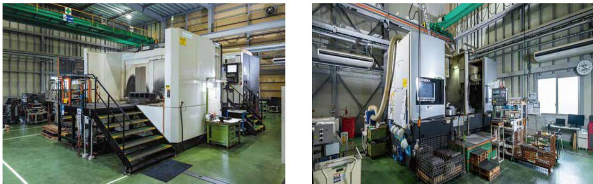
写真⑥ 左～横形マシニングセンタ、右～立形 NC 旋盤（鳶製作所提供）
