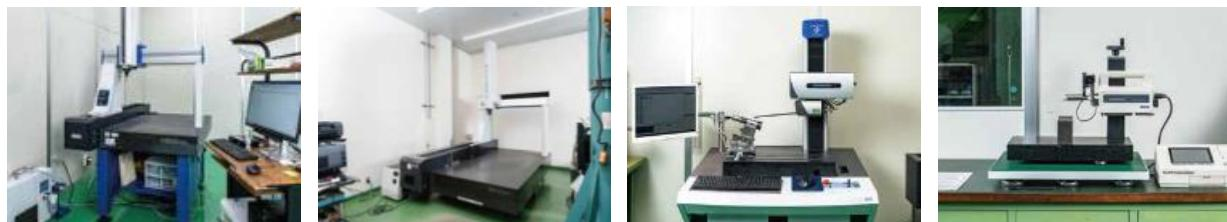
写真⑦ 左から汎用三次元測定機、大型 CNC 三次元測定機、形状測定機、粗度計。右上は汎用三次元測定機での測定の様子（鳶製作所提供）
