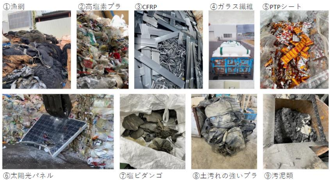
(写真③) 製鋼副資材に加工可能な処理難物の例 (大瀧商店提供)
