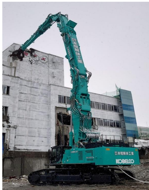
写真：超ロング高所専用機（35m）「SK1300DLC」
