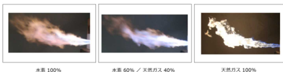
(出所：日本電気硝子 ニュースリリースより 燃焼の様子)
