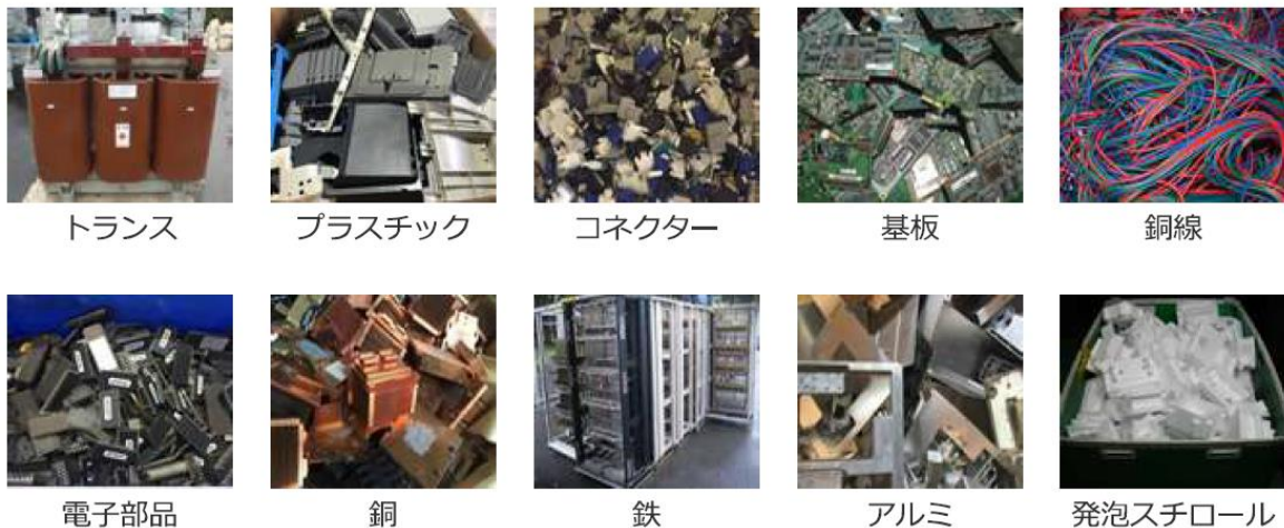
図②：解体・分別後の素材
