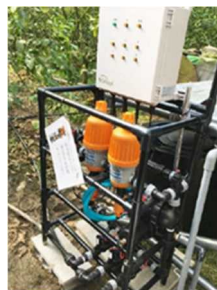
図 11 栽培データの蓄積と施水・施肥を AI にて自動化できる設備 16
