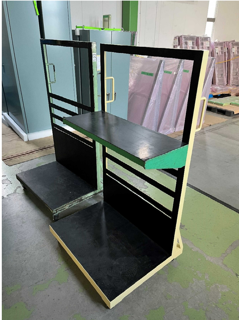
特注の台車（作業台を4段階で設置可能）
