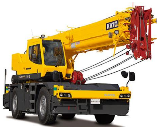
(写真①) ラフテレーンクレーン（創紀提供）
