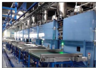
旧型乾燥機（重油式）：左 新型乾燥機（LNGガス式）：右 当社提供写真
