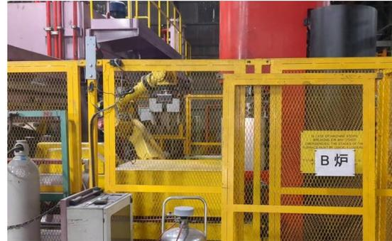
マグネット式加熱炉は、従来の加熱炉と比較し、2割の電力削減を実現した。
