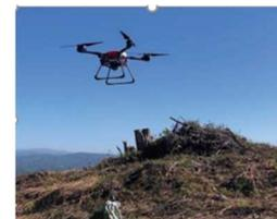
（写真⑩）ドローンによる苗木運搬
