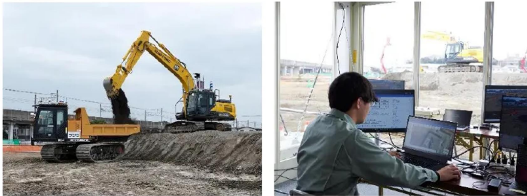
図表 26 ショベルとクローラダンプの協調による自律積み込みと自律運搬の実証試験
