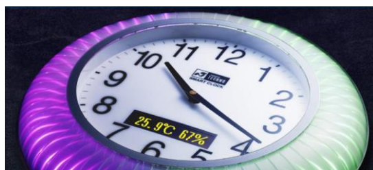
【スマートクロック】 電力使用量の目標との対比を緑から赤色までの LED で知らせてくれる
