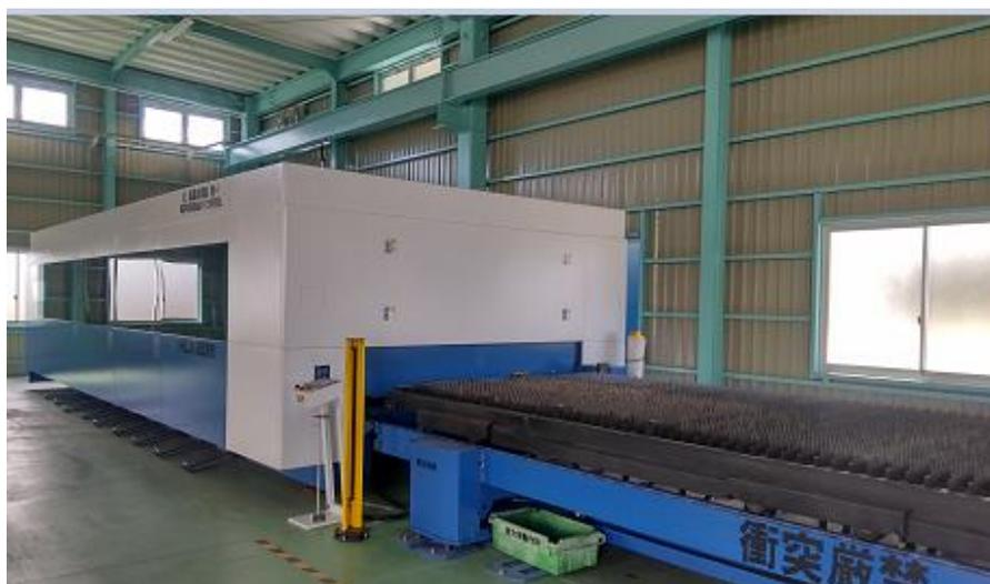
Yawei 社 HLX シリーズ平板加工用超高速ファイバーレーザー加工機
