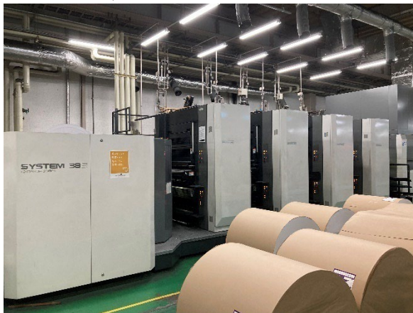
印刷ユニット部（4色のインキ毎にユニットが分かれている）
