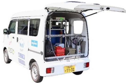
プールから汲み上げられ、深紫外線浄水装置車に届けられた水は、ろ過フィルター・活性炭フィルターを通り、深紫外線殺菌装置により殺菌され、蛇口より供給される仕組み。25mプールを利用すると、水道水の安全基準をすべてクリアした水を、1万人に対して毎日3リットル、10日間供給することが可能となる。
