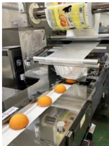
写真② カスタードケーキライン製造工程（出典：熊本菓房提供）
