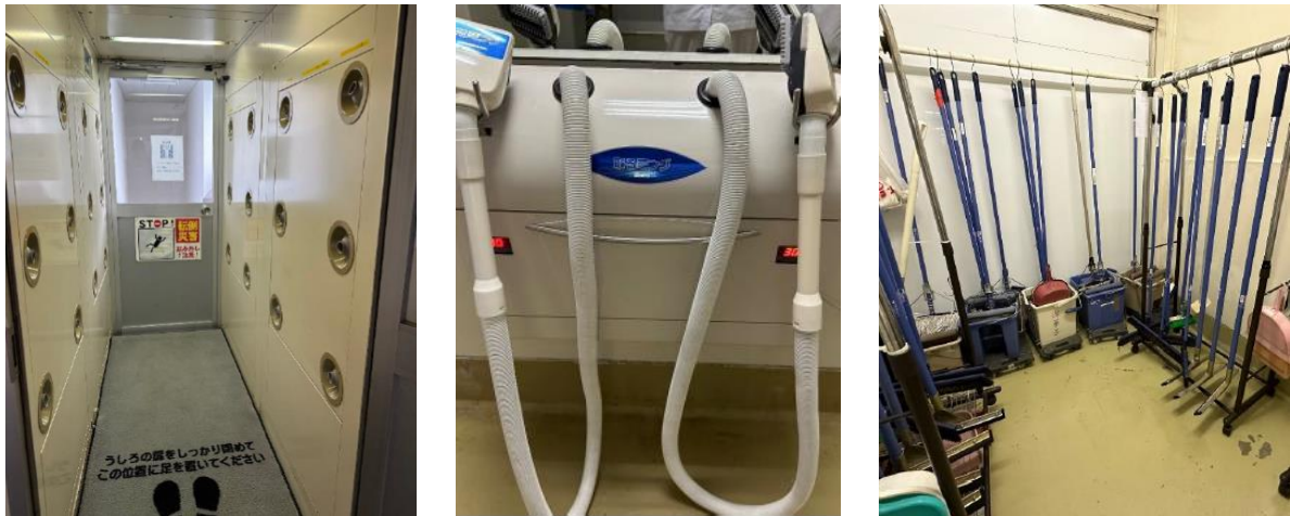
写真⑧ 食品安全対策のための機械装置や道具（左～エアシャワー室、中～毛髪塵埃除去機、右～清掃用具保管室） （出典：熊本菓房提供）
