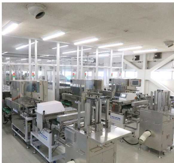
＜熱気が漏れないように工夫された生産ライン及び検査機械＞
