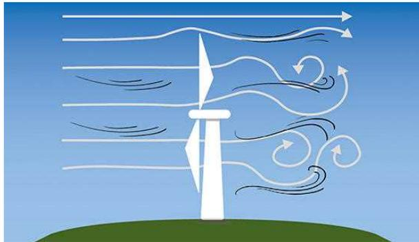
図表 4 風車の後流・乱流の概念図<sup>14</sup>
