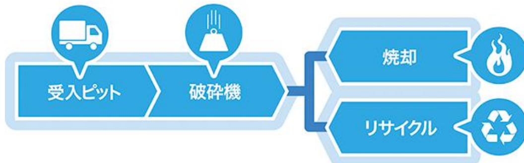
＜破砕機（二軸）を活用した処理方法＞
