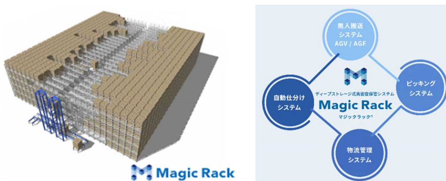
【図 25】 高密度保管システム マジックラック®
