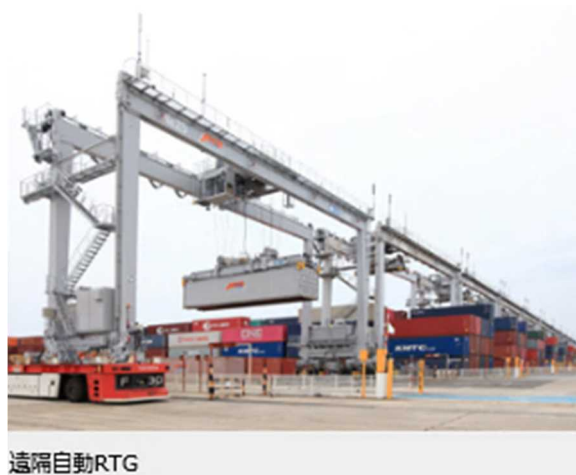
【図 26】 遠隔自動 RTG
