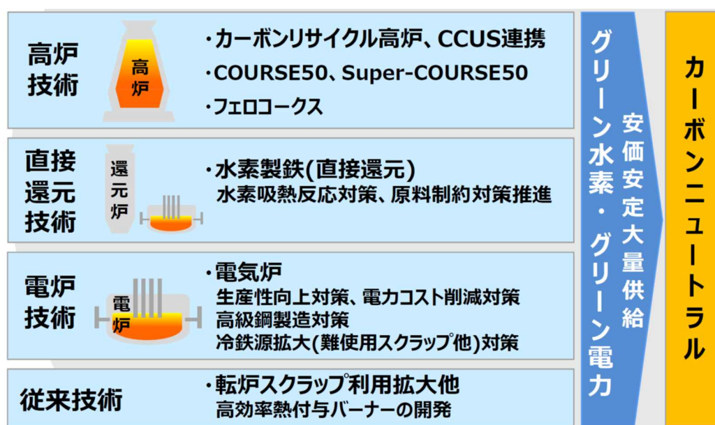
図 3：複線的アプローチによる製鉄プロセスの CO 2 削減策
