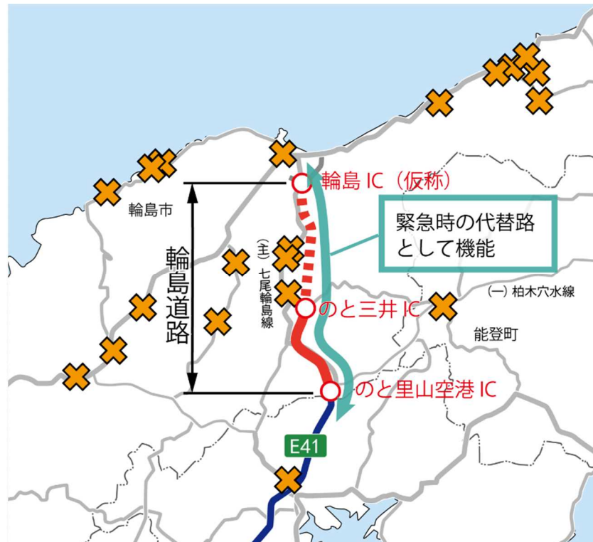
図 10：輪島道路と輪島市に繋がる各道路の通行規制発生箇所 14
