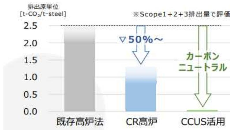
図 18：カーボンリサイクル高炉の CO<sub>2</sub> 排出原単位<sup>36</sup>
