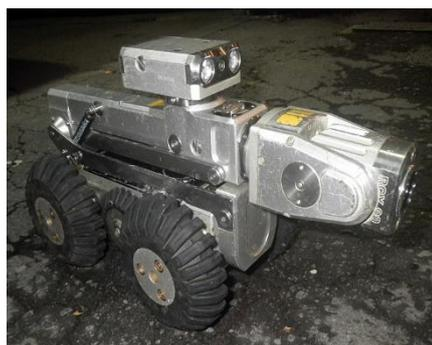
写真：下水道管内カメラ
