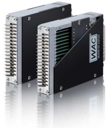
ワックデータサービスはこの繊維機械用アクチュエータで世界に先駆けて圧電セラミックスを採用した。圧電セラミックスの特徴の一つでもある極めて低い自己発熱や低電力消費により、アクチュエータの高速動作が可能となり、編機の高速化ニーズに適合することとなった。また圧電セラミックスを組込んだ従来にはない高精度で小型なアクチュエータ構造の開発により、生地の生産量向上に貢献した。
