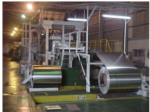
資料④：縦吊り全自動アルマイト（滋賀第一工場） コイルアルマイト連続処理設備（同第二工場）
