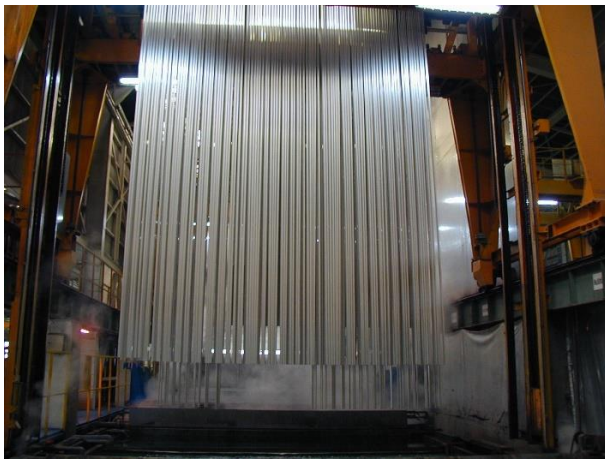
資料④：縦吊り全自動アルマイト（滋賀第一工場） コイルアルマイト連続処理設備（同第二工場）
