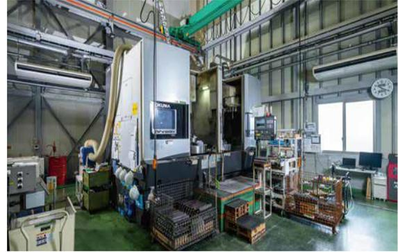
写真⑥ 左～横形マシニングセンタ、右～立形 NC 旋盤（鳥製作所提供）
