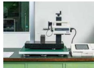
写真⑦ 左から汎用三次元測定機、大型 CNC 三次元測定機、形状測定機、粗度計。右上は汎用三次元測定機での測定の様子（鳥製作所提供）
