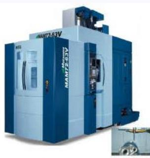
同時5軸加工機によるミリング加工
