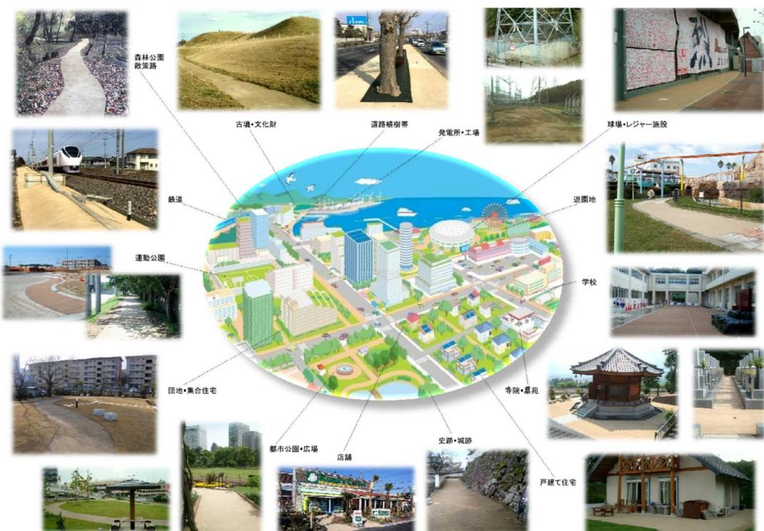
ガンコマサは徳島県に本社を置く(株)ワイ・ビー・ケイ工業が開発した自然土舗装材・防草材で、真砂土を完全乾燥し、固化剤と一定の割合で混合したものである。施工場所に敷き均し、散水・養生するだけで真砂土を固化させ、強固な保護面をつくり施工部の保護、雑草の生育防
