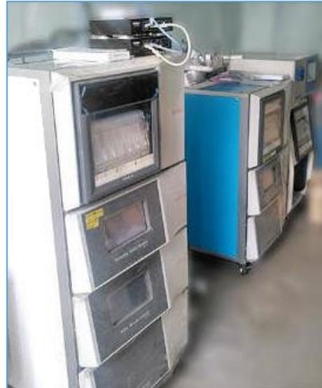
(写真②) 窒素酸化物測定器 NA-721
