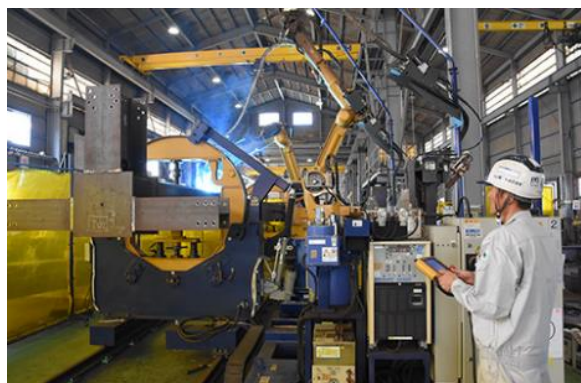
（写真⑤）溶接ロボットによる溶接風景（山口重工業提供）
