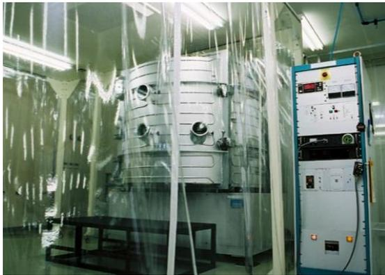
写真① 真空蒸着加工装置（カツヤマテクノロジー提供）
