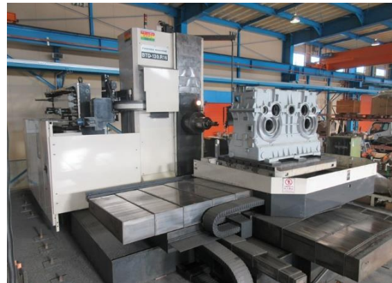
（写真⑨）横型マシニングセンター
